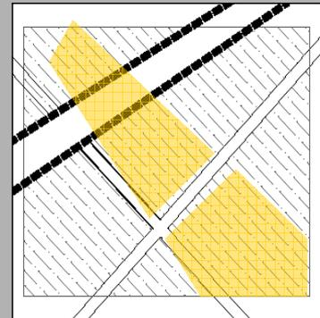
stato di progetto: ampliamento di una viabilità secondaria con aumento dell'effetto barriera e della frammentazione
