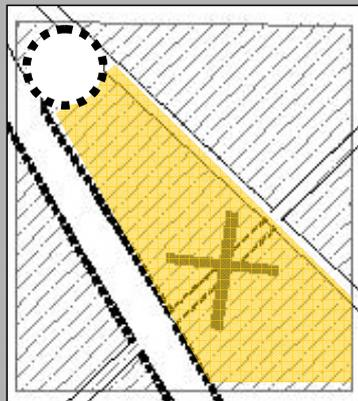
mitigazione: ridefinizione della viabilità secondaria a mezzo di una rotonda, con dismissione e recupero di un tratto per accorpamento lotti
